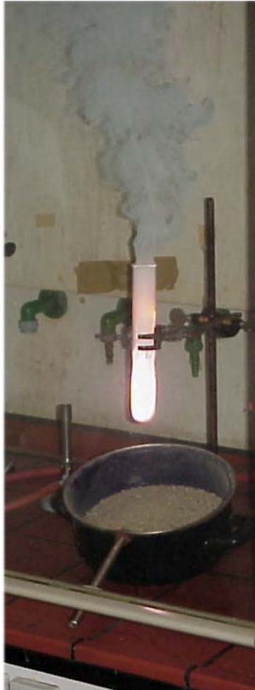
Abbildung 7: Ein Gummibärchen verbrennt in einer Kaliumchlorat-Schmelze unter heftiger Energiefreisetzung.
