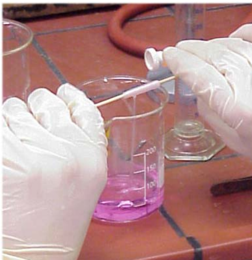
Abbildung 4: Nassspinnen von Nylon 6,10. Nylon ist ein Polykondensat (Polyamid) aus einer Disäure und einem Diamin.
