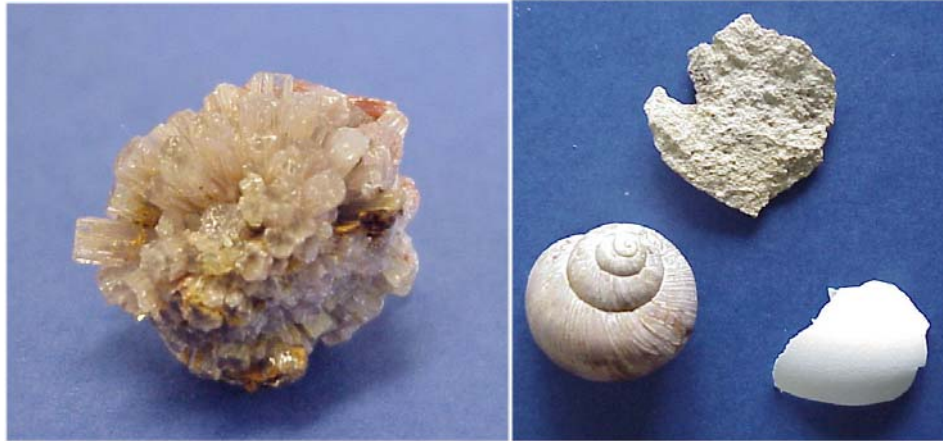
Abbildung 5: Calciumcarbonat kommt in verschiedenen Formen in der Natur vor. Links: Aragonit, rechts: Calcit in Eierschalen und Kalkstein. Schneckenhäusern, Weichtiere bilden sowohl Calcit (Hauptmenge), wie auch Aragonit in der Perlmuttschicht. Das Schneckenhaus enthält also beide Modifikationen.
