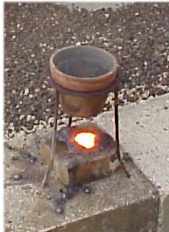
Abbildung 3: Aluminothermische Eisendarstellung (Thermit-Versuch). In den Blumen-opf gibt man die Mischung aus Aluminiumpulver und Eisen(II)oxid und zündet. Das flüssige Eisen tropft aus der Reaktionsmischung.
