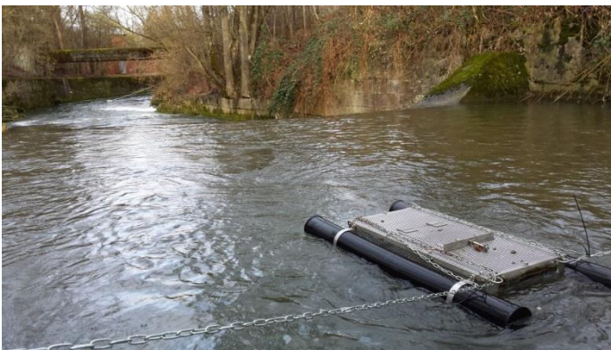
Versuchskäfig zur Haltung von Regenbogenforellen in den untersuchten Gewässern. Foto: Rita Triebkorn
