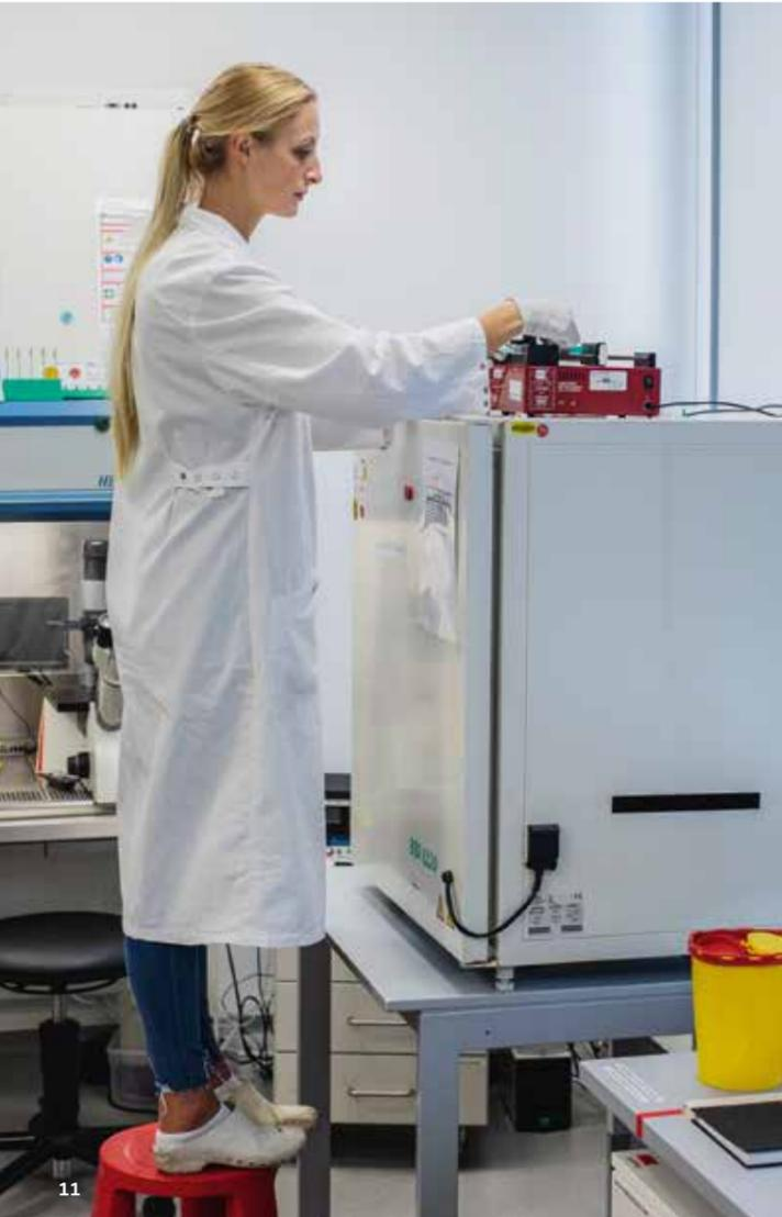
**11** Ein Chip-System wird über Pumpen an die Nährlösung angeschlossen.
