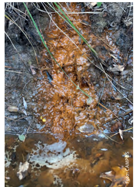
Wasserzutritte nach Sanierung der Drainagen entlang des Ammertal-Radweges beim Tübinger Stadtteil Unterjesingen. Bemerkenswert sind die nach Sauerstoff-Zutritt erfolgten Ausfällungen von Eisenhydroxid.
