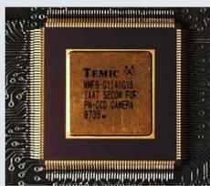
**ASIC:** strahlungsfester Integrierter Baustein (ASIC), der am Institut zusammen mit der Industrie speziell für XMM-Newton entwickelt wurde.
