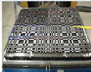
**Kodierte Maske:** indirekte Abbildung durch "Multiple-Loch-Kamera"
