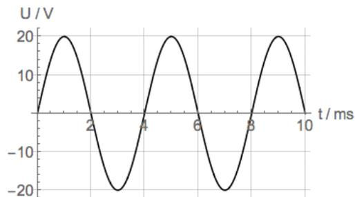
Wie groß ist die Frequenz dieser Wechselspannung?
