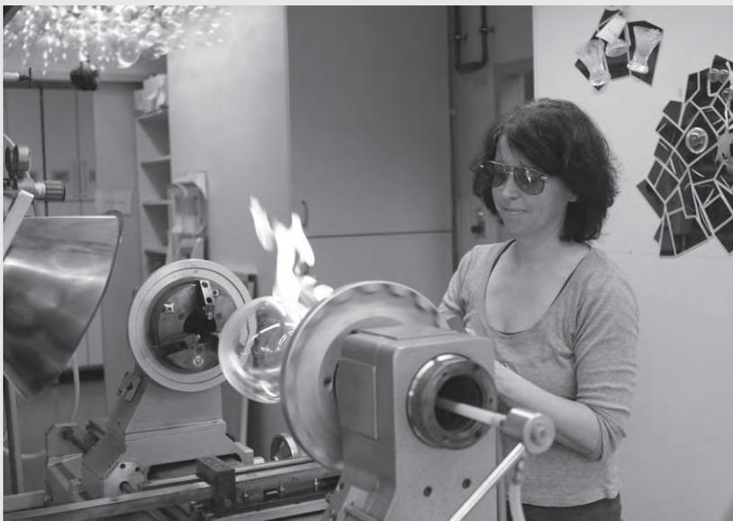
Karin Rein an der Drehbank: Die getönte Brille filtert das gelbe Licht der Flamme heraus.
